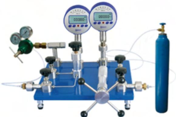
HNv气体减压器校验装置,采用最新设计方案,对气瓶减压器整体检定,检定时将气体减压器及压力表作为一个整体,无须拆卸检定,大大提高了检定效率,并能正确判断出气体减压器性能状况的好坏,避免了减压器传统检定方法所引发的各种问题,具有不会污染、防腐蚀性,没有拆装对整体结构密封的影响。
