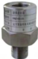
用途一：很脏的压力仪表检定时，用它起隔离作用，以免污染损坏压力泵、活塞压力计，本产品起到绝对过滤的效果，完全杜绝了被检表对压力泵、活塞压力计的污染。
